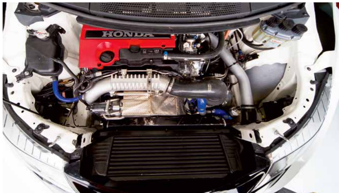
Vista del quattro cilindri 2.0 litri turbo Honda accreditato di 330 cv. In primo piano l'intercooler, dietro il gruppo turbocompressore, coperto da materiale anticalore, e la presa d'aria dinamica con cassoncino filtro in carbonio.
