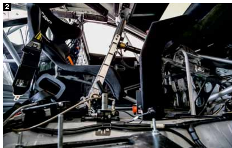
1. La gabbia di sicurezza si collega nella parte posteriore ai passaruota. Appena avanti, il serbatoio benzina, posto nell'area dei sedili posteriori. 2. Si nota l'arretamento del posto guida, per bilanciare i pesi, con il sedile al limite dei tubi roll bar e l'allungamento del piantone sterzo. In primo piano, la levetta del regolatore di frenata e quella del freno a mano per le partenze. 3. Il volante, estraibile e con i paddle solidali, con integrati i comandi principali e il cruscottino digitale, in basso la pedaliera scorrevole.
