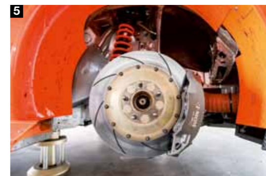
4. La sospensione anteriore con il triangolo realizzato ex novo, così come il montante. Si nota il fissaggio dell'ammortizzatore, KW regolabile, nella parte posteriore del montante, per ottimizzare il Caster. In primo piano il braccetto dello sterzo, con regolazione della convergenza. 5. Il disco freno anteriore, autoventilato e baffato, da 378 mm con pinza a quattro pompanti. 6. La sospensione posteriore, a ponte rigido, con aggiunta la barra antirollio regolabile. 7. Il quattro cilindri Opel 2.0 turbo in versione TCR eroga 350 Cv a 6.500 giri/min. In primo piano, in posizione alta e inclinata, l'intercooler. 8. Il cambio Sadev sequenziale a sei rapporti. 9. Lo splitter anteriore, in composito, uguale per tutti.
